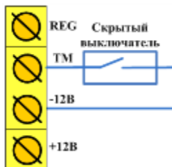
Рис. 7.2. Схема подключения скрытого выключателя
