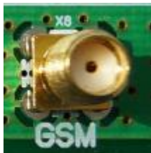
Рис. 4.3. SMA-разъем для подключения GSM-антенны
