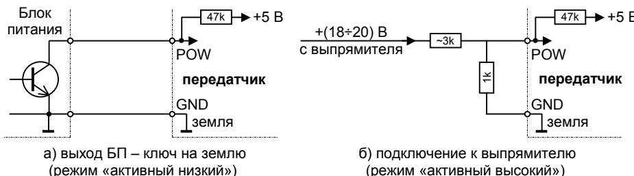
Рис. 2. Примеры монтажа входа POW (контроль сети 220 В)
