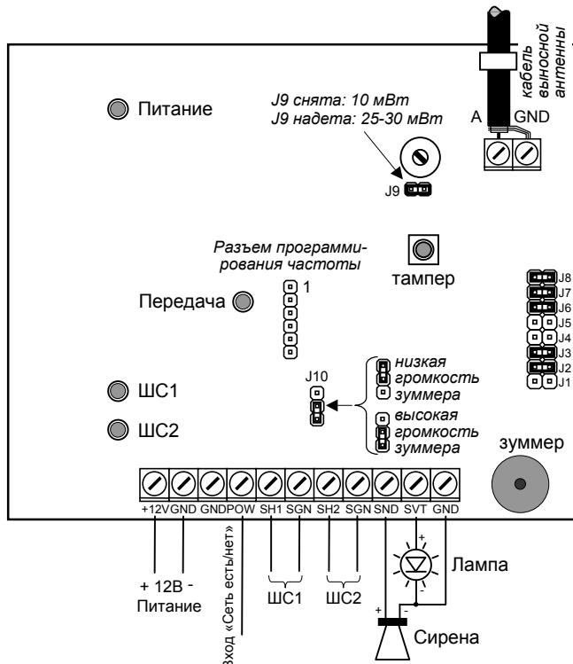
Рис. 3. Монтажная схема передатчика
