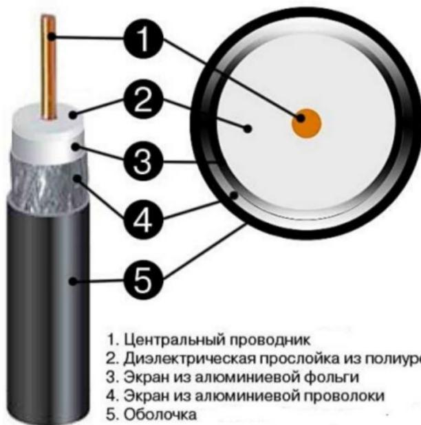
**Важно, чтобы центральная жила не соединилась хоть с одним из проводов оплётки – это может привести к короткому замыканию и приведет к отсутствию сигнала на видеокамере.**
