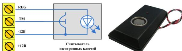
Рис. 8.3. Схема подключения считывателя Touch Memory
