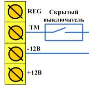
Рис. 8.5. Схема подключения скрытого выключателя
