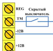
Рис. 10.5. Схема подключения скрытого выключателя
