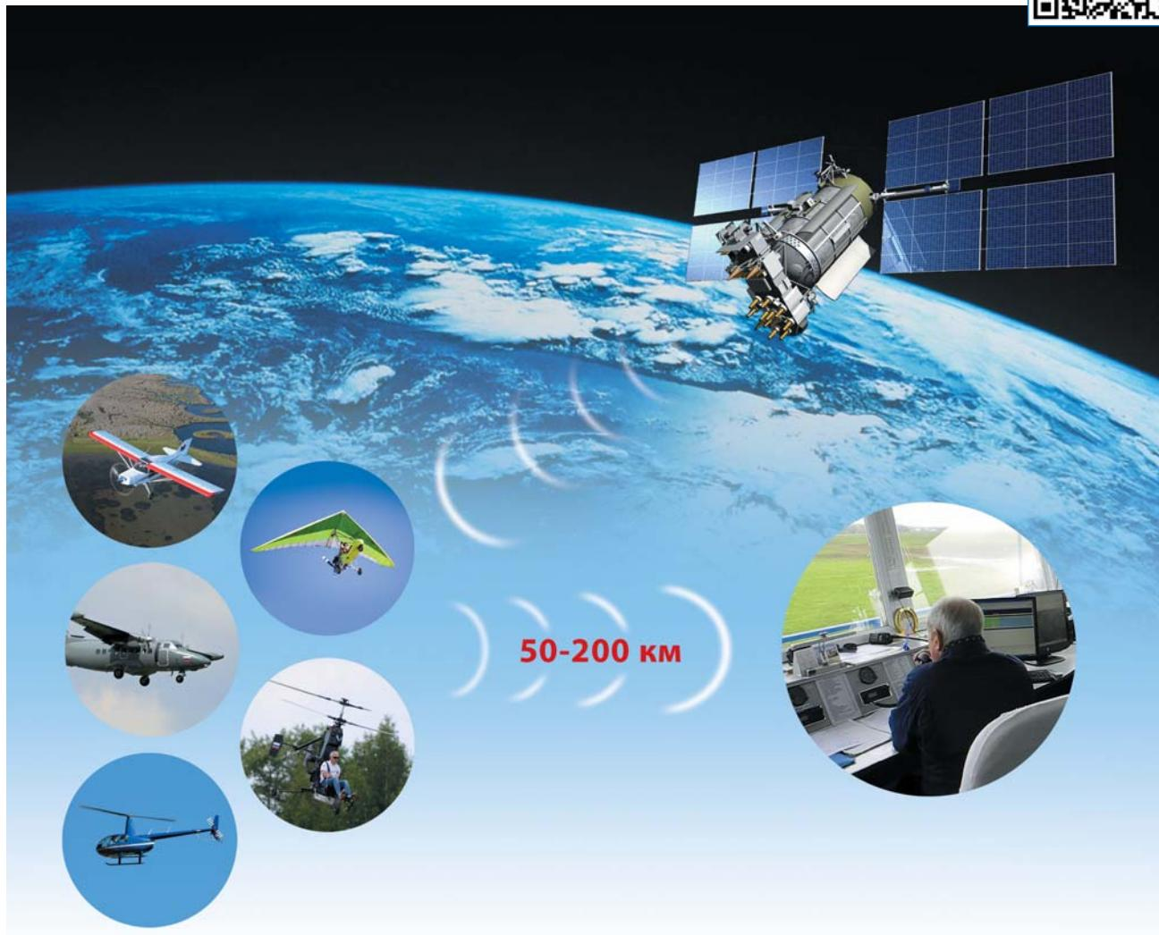
Комплекс предназначен для контроля местоположения летательных аппаратов малой или спортивной и учебной авиации путем передачи информации по радиоканалу координат, направления, высоты и скорости полета полученных от ГЛОНАСС/GPS навигационных систем.
